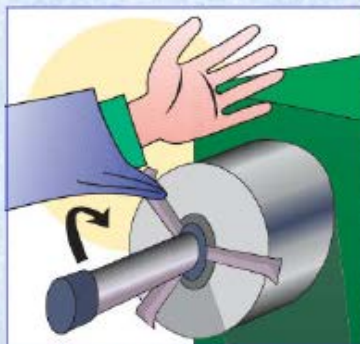
Impigliamento degli indumenti nel mandrino rotante con conseguente trascinarsi nella rotazione.
