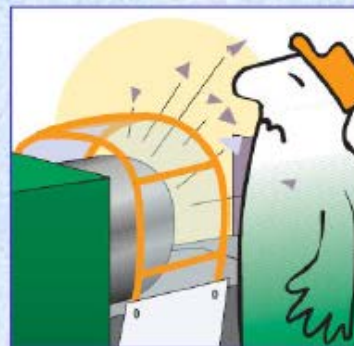
Proiezione del materiale in lavorazione per effetto della forza centrifuga..
