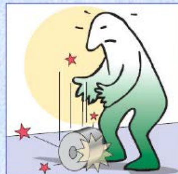
Schiacciamento degli arti con il mandrino durante la sua sostituzione.
