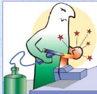
Pericolo ustioni per ritorno di fiamma al cannello, dovuto a ostruzione e/o contatto con le parti fuse.
