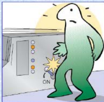
Avviamento accidentale della macchina, specialmente nei torni di vecchia costruzione dove il comando di messa in moto del mandrino è del tipo a leva sporgente.
