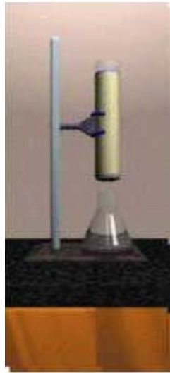
Cromatografia su colonna: fase stazionaria contenuta in colonne di vario diametro
