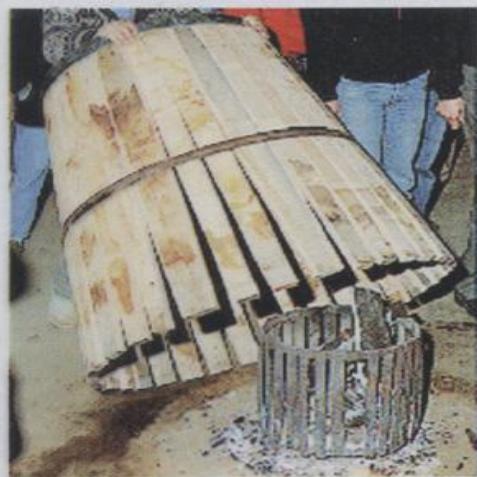
* Figure 38, 39, 40, 41, 42 e 43 - Successione delle fasi di curvatura a fuoco delle doghe (Gamba).
