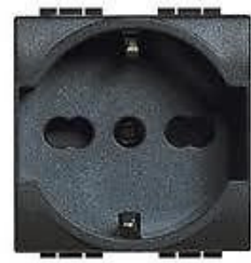
presa schuko con contatti laterali e 3 alveoli centrali per spine a poli allineati da 10/16 A (schuko universale)
