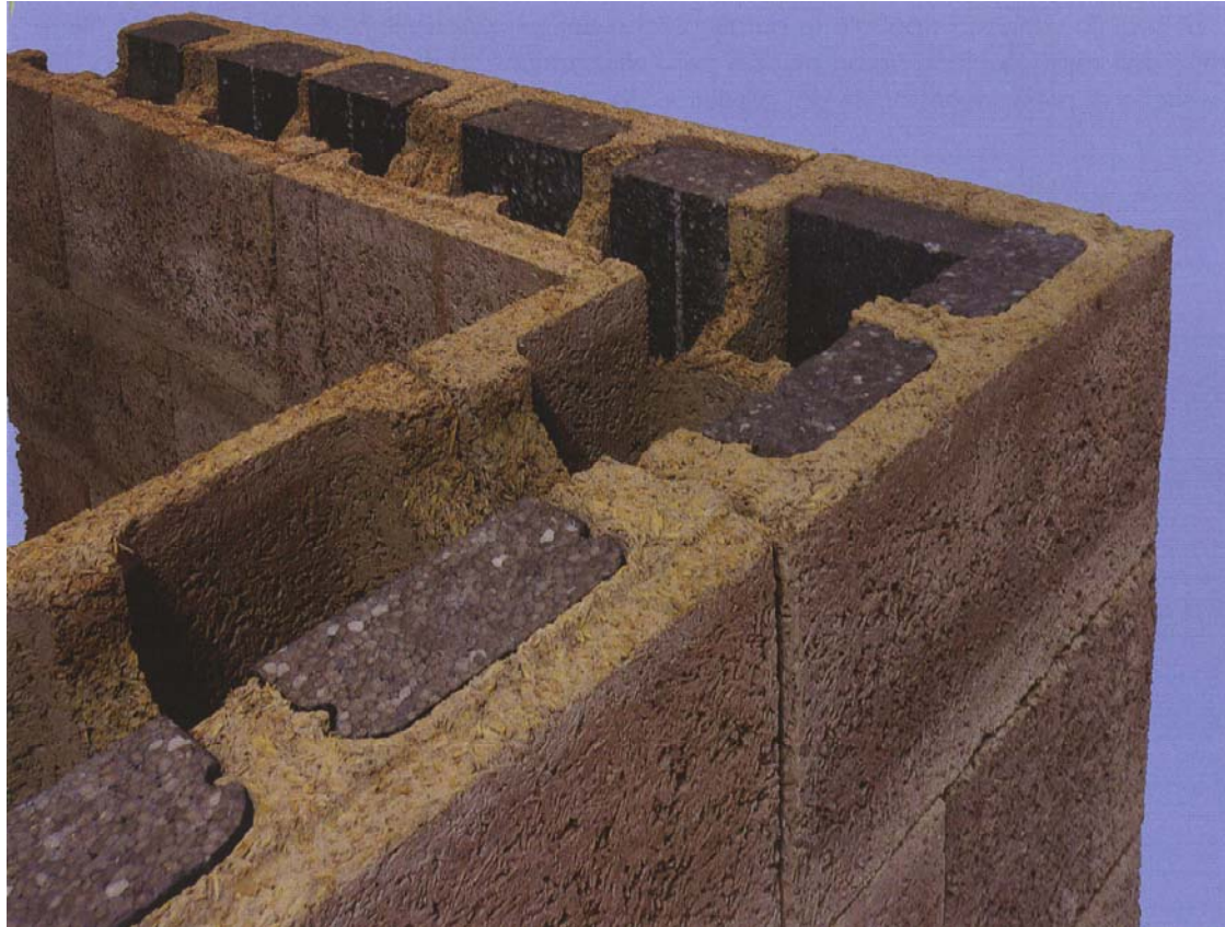
Casseri a perdere o blocchi in fibra di legno mineralizzata accoppiati a isolante in EPS per la realizzazione di setti portanti in cls armato coibentati
