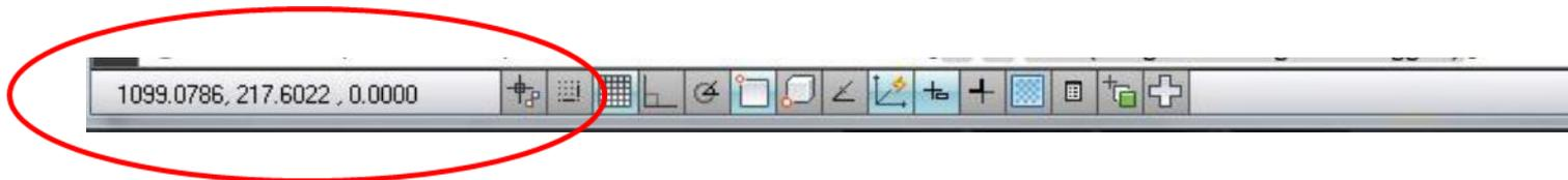
Nel piano in un disegno 2D, per individuare un punto si indicano solo le due coordinate X e Y. Il sistema assegna a Z il valore zero.
