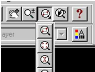
**Pan:** Sposta la visualizzazione del disegno nella finestra corrente mantenendo il fattore di ingrandimento costante.
